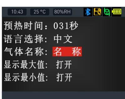
**显示最大值：**选择打开就在单通道界面显示本次测量的最大值和上次测量的最大值，如右图：
