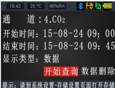
如果没有查询到记录，说明了数据存储功能没有开启需要在“系统设置”→“存储设置”里开启存储功能。选择“定时存储”即实时存储功能并设置存储周期（时间间隔），如右图：
