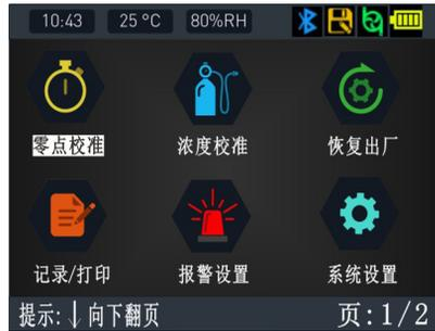
通过“◀”键和“▶”键选择要校准的通道，按“■”键进行零点校准，如下图：
