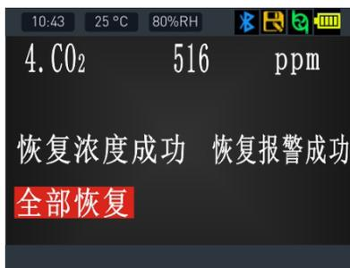
当设置错误或测试浓度不准确时需要进行恢复出厂的操作，如果是人为因素造成的不良可以得到恢复，可以恢复出厂的参数：零点校准值、浓度校准值、报警值、报警方式、报警模式、最大量程。
