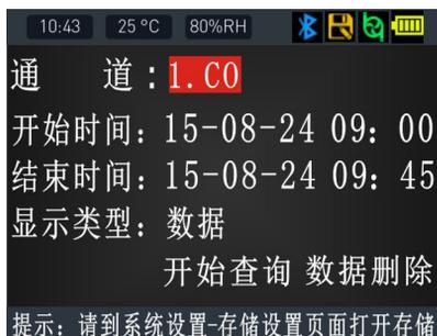
通过“◀”键和“▶”键选择到“开始时间”，按“■”键进入设置查询起始时间。通过“◀”键和“▶”键选择到“结束时间”，按“■”键设置查询结束时间，如下图：
