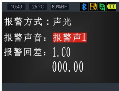
**报警回差：**即报警回程差，可设置每一通道的报警回差值，如果设置为0，只要数值达到报警设定值就马上报警，若不想数值在报警设定值的临界点发生频繁报警，可以把报警回差设置一定的数值按“■”键可以切换要修改的通道按“▶”键可以修改数值，如右图：
