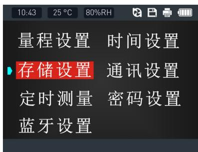
**存储方式：**可设置定时存储、报警触发两种模式“定时存储”是在每个存储周期时间内存储数据一次，如右图：
