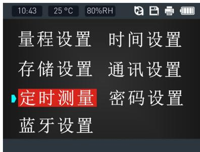
默认的测量时间是0秒，如果不修改这个数值，此功能不起作用，当修改为一定的数值，此功能开始起作用，若要使用定时测量的功能。一般情况需要把数值修改为30到60秒，按一下泵的开关“PUMP”键开始测量，达到设定的时间就停止测量。定时测量的界面:显示屏底部显示设定的时间和剩余时间，如右图:
